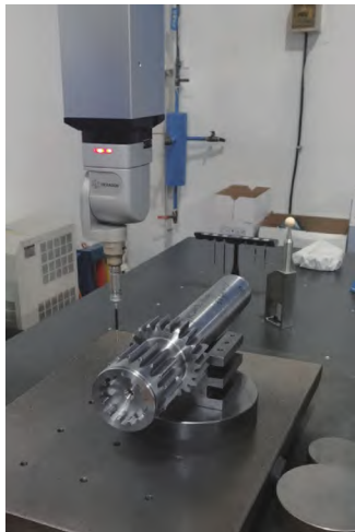
图2 三坐标检测位置度
