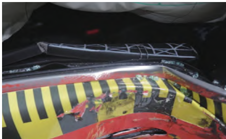
图5 门板和钣金同步变形
