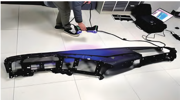
图2 汽车零件3D扫描
