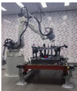
图1 机器人激光飞行焊接平台
