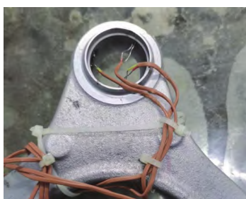
图5 焊完热电偶的臂体
