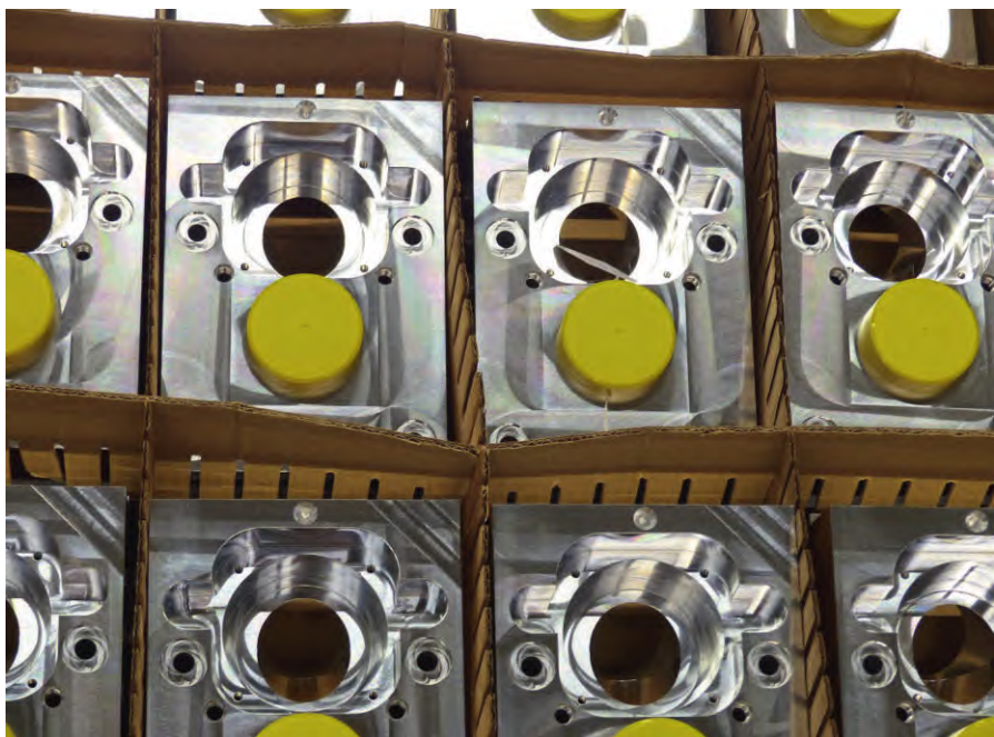
图 2 Zeltwanger 公司生产的主要是一些结构形状非常复杂的、精度高的铝合金零件
