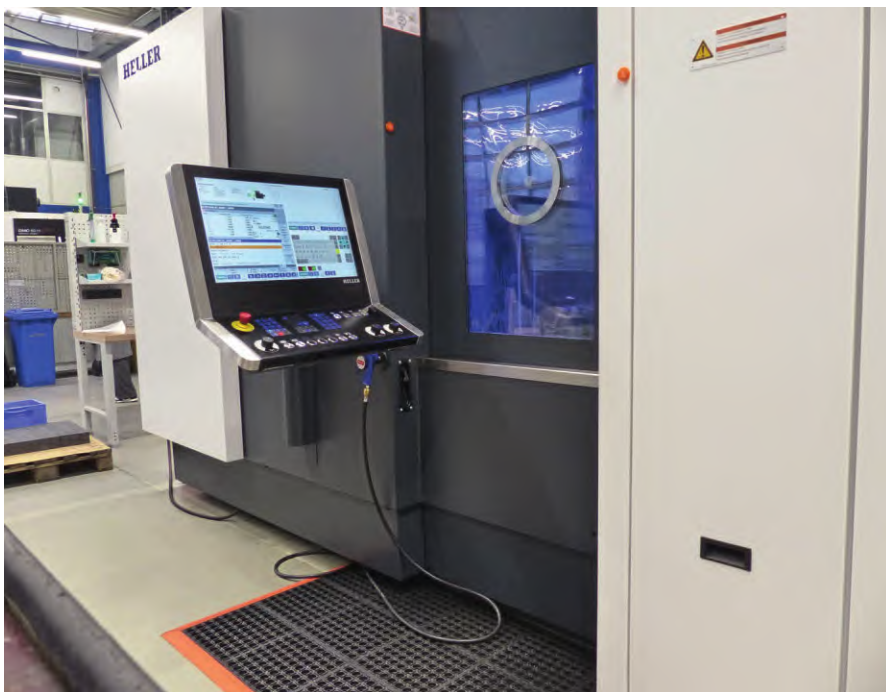
图 1 2023 年 Zeltwanger 公司投资购买了 HF 5500 型五轴加工中心。截至目前，这台已经运行了六个月的设备具有令人信服的加工精度、重复精度和工艺可靠性
