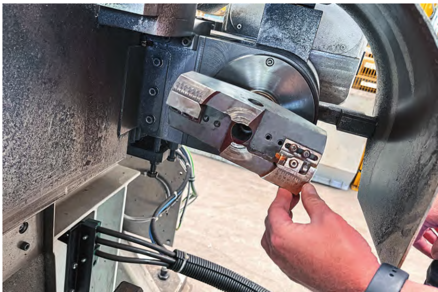
图3 利用短柄刀具，Gabo 钢铁公司的职工可以快速、简单地完成不同直径零件的倒角加工任务
