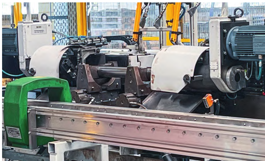
图2 Mössner 公司加工设备可以同时完成圆钢棒料两端的切削加工
