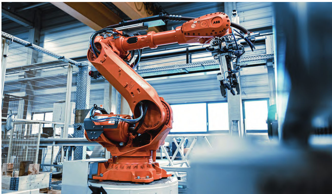
图 1 Mössner 公司研发生产的切割设备能够完成直径从 30 ~ 100 mm、长度尺寸从 300 ~ 2000 mm 所有圆钢产品的端面切削。与其配套使用的是一台上下料机器人
