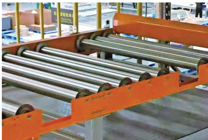
图8 田字底托盘在辊筒机插取位预留空间方式输送系统中的应用
