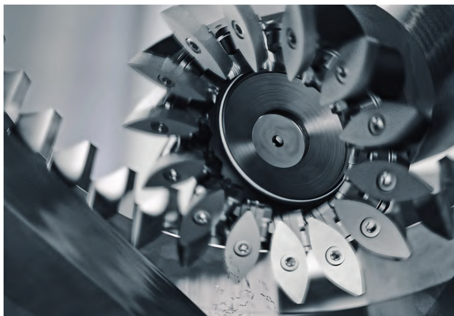
图 2 Sandvik Coromant 公司研发的高品质 Coro Mill 180 强力刮齿刀具；并针对电动汽车变速系统的精密加工而优化
