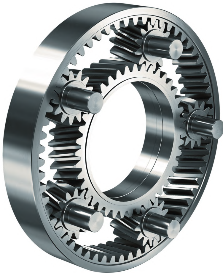
图 1 电动汽车中的减速装置一般都设计为行星齿轮减速器，其中的行星轮和太阳轮都在一个结构紧凑而且轻便的内齿圈中
