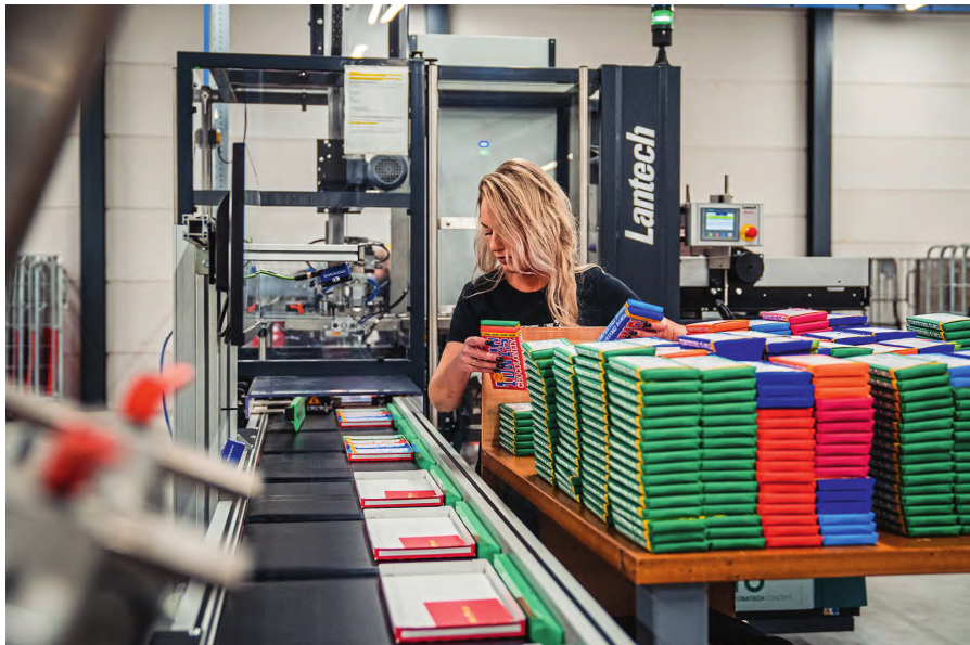
图3 巧克力被装入信封式的包装盒中并由 LA Parcel 封口机完成封口
