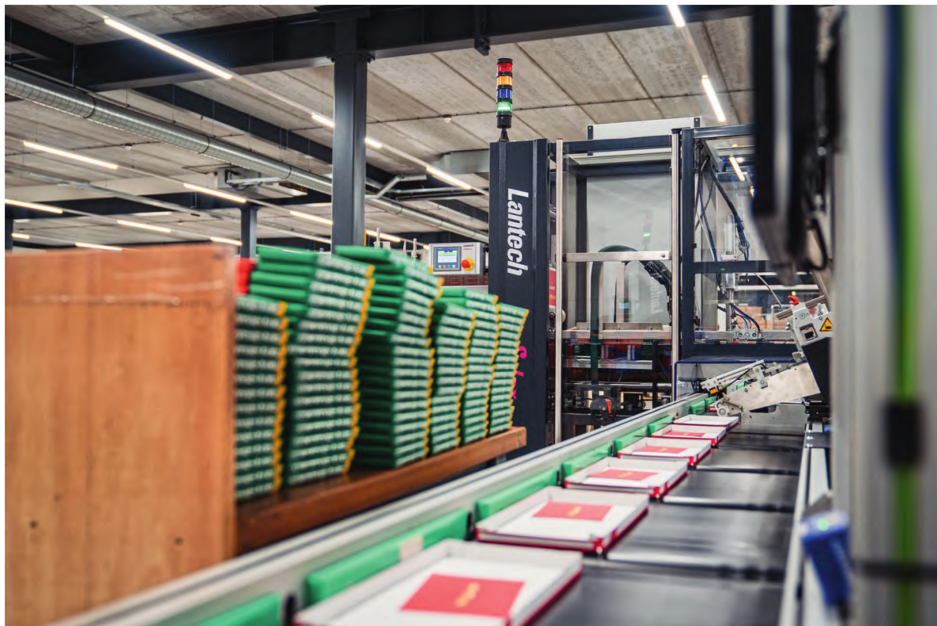
图 1 TE Parcel 纸板包装箱包装设备最多可以展开信封式包装盒 1000 个 /h
