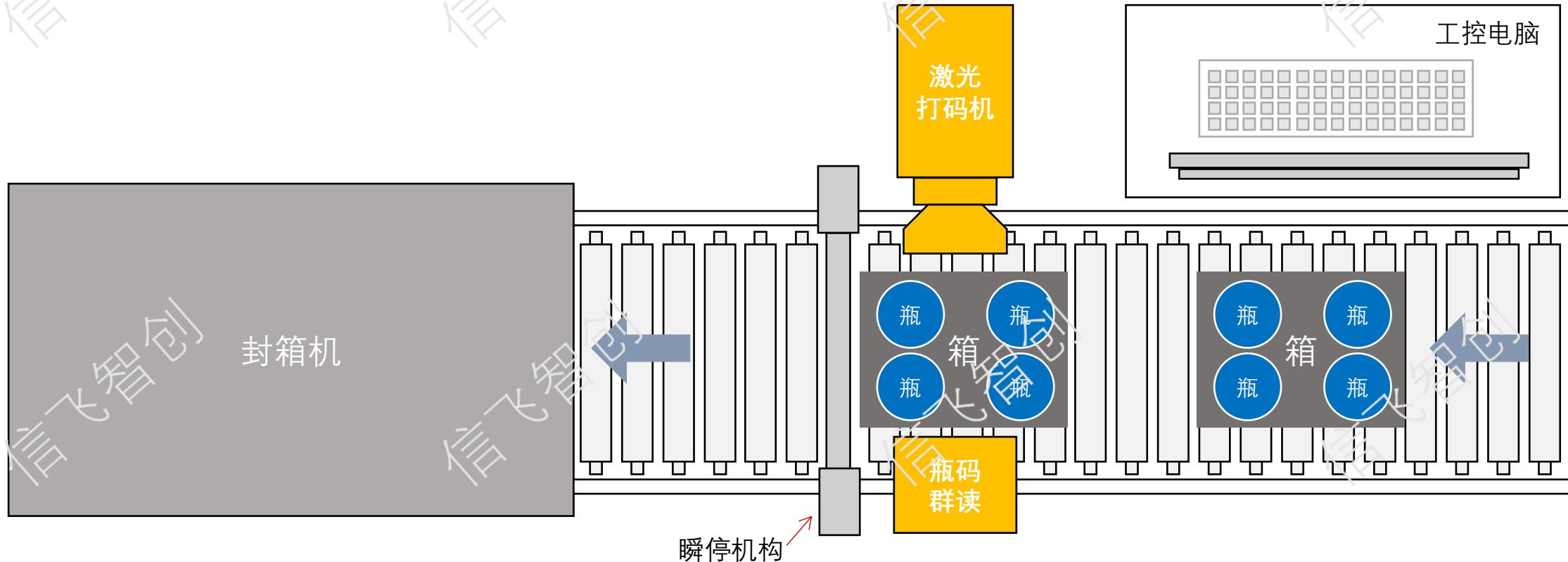
新增设备：激光打码机\*1、大视野读码器 \* 1 、工控机\*1
