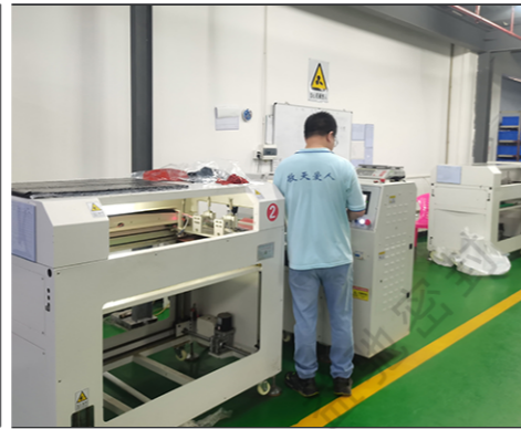
自动切条机 精准材料，保证尺寸精度
