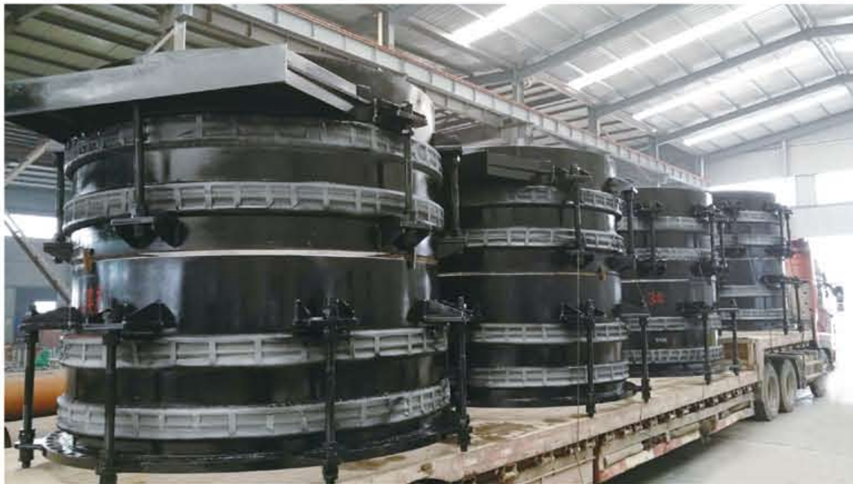
循环水管道膨胀节
