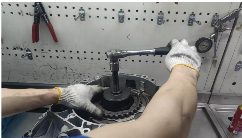
9、拆掉机电单元
