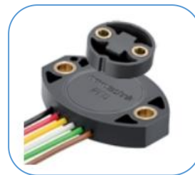
角度传感器壳体 刹车踏板, 油门踏板角度检测, 无人驾驶车轮方向检测等. 鱼眼Pin针、铜套、转动轴铜套嵌件注塑
