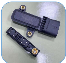
线性位移传感器壳体 用于离合器, PRD档位置检测等 Pin针、铜套、磁铁嵌件注塑
