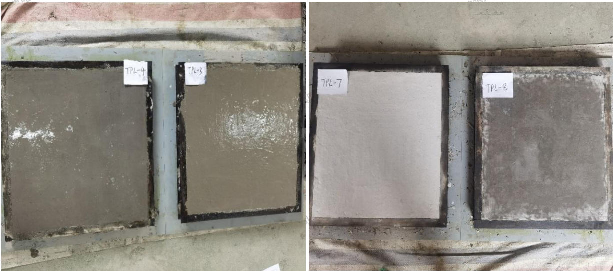
(a) 抗裂试件第二遍喷涂
