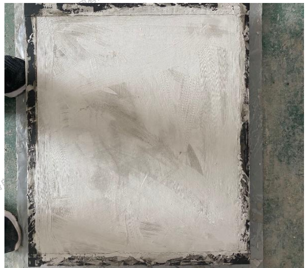
(b) 内掺 0.5%+外涂组抗裂试件
