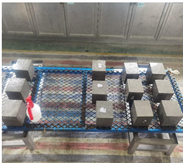
(a) 外涂组抗压强度试件喷涂 DPS (b) 外涂组抗压强度试件喷涂 DPS 完成
