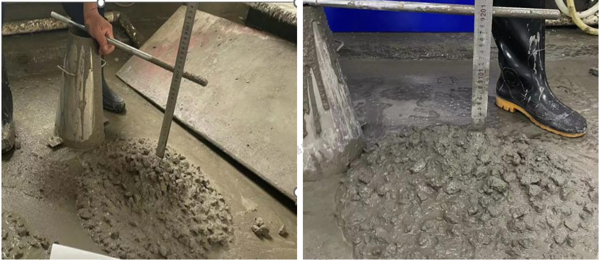
(a) 基准组配合比坍落度 205mm (b) 内掺 0.5%配合比坍落度 200mm
