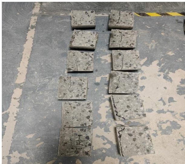
(a) 基准组试件劈开图
