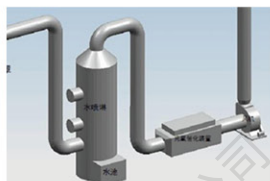
废气除臭装置
