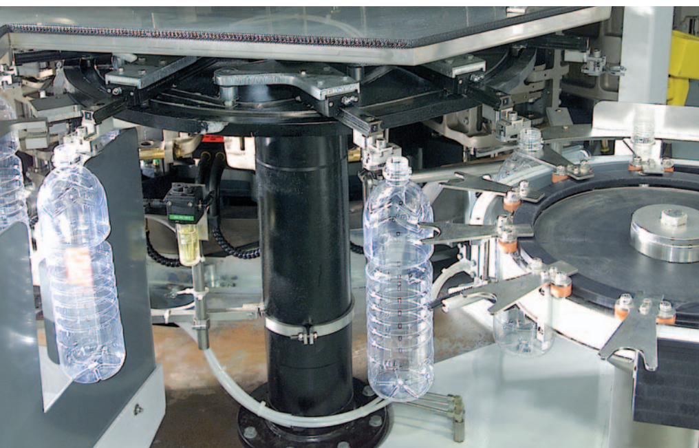
外圈表面和支承轨道无磨损：INA带Triondur 涂层支承型滚轮，用于PET瓶灌装机星轮传输单元的凸轮控制系统中（图片：KRONES）。
