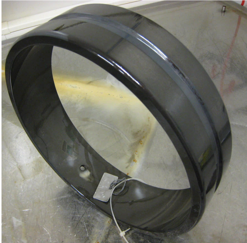
Etched ring 酸洗后的轴承套圈
