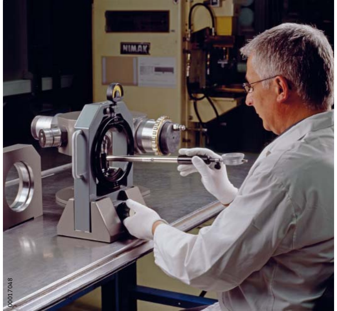
图 3 将测得的直径传递给包络圆量规
