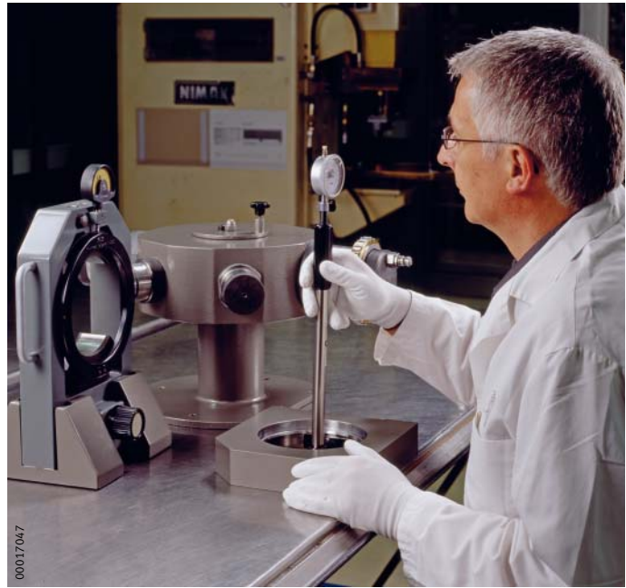
图 2 测量外圈的滚道直径
