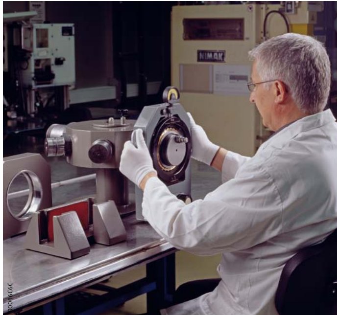
图 4 包络圆量规的位置调整
