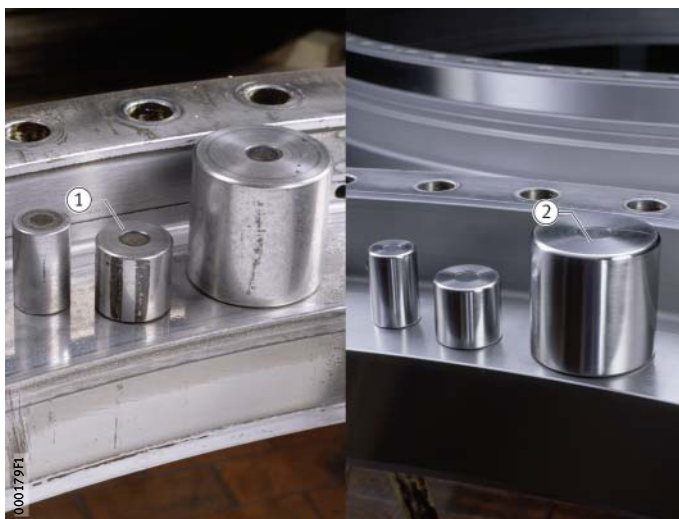
图7 滚动轴承的滚道和滚子 修复前和修复后
