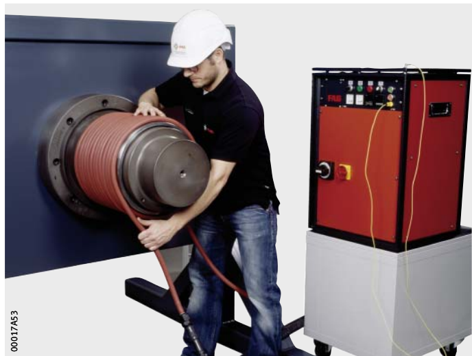
图 1 柔性感应器可缠绕于零件上
