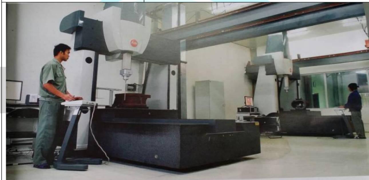
德国 HEXAGON 三坐标测量仪
