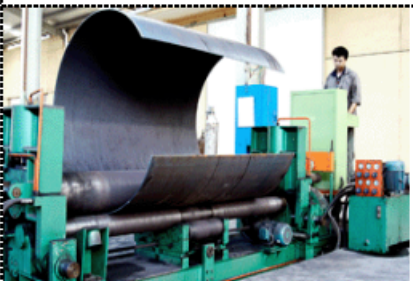
压力容器大型卷板机
