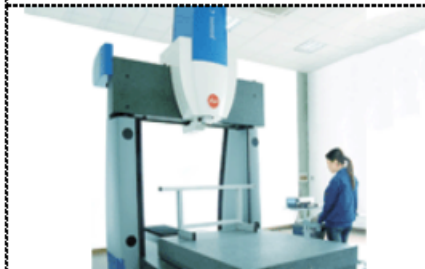
德国 HEXAGON 三坐标测量仪
