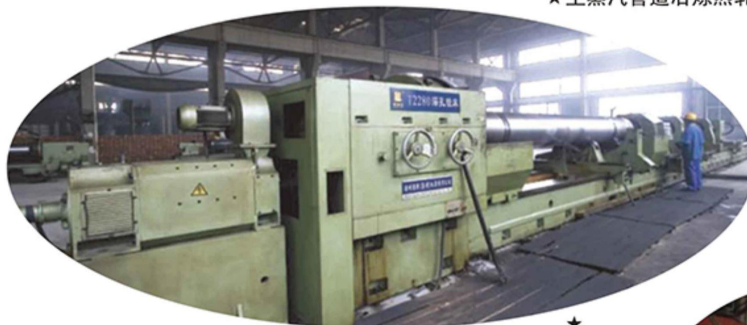
★主蒸汽管道表面处理设备
