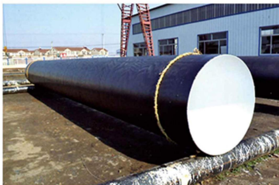
两布三油内防腐钢管
