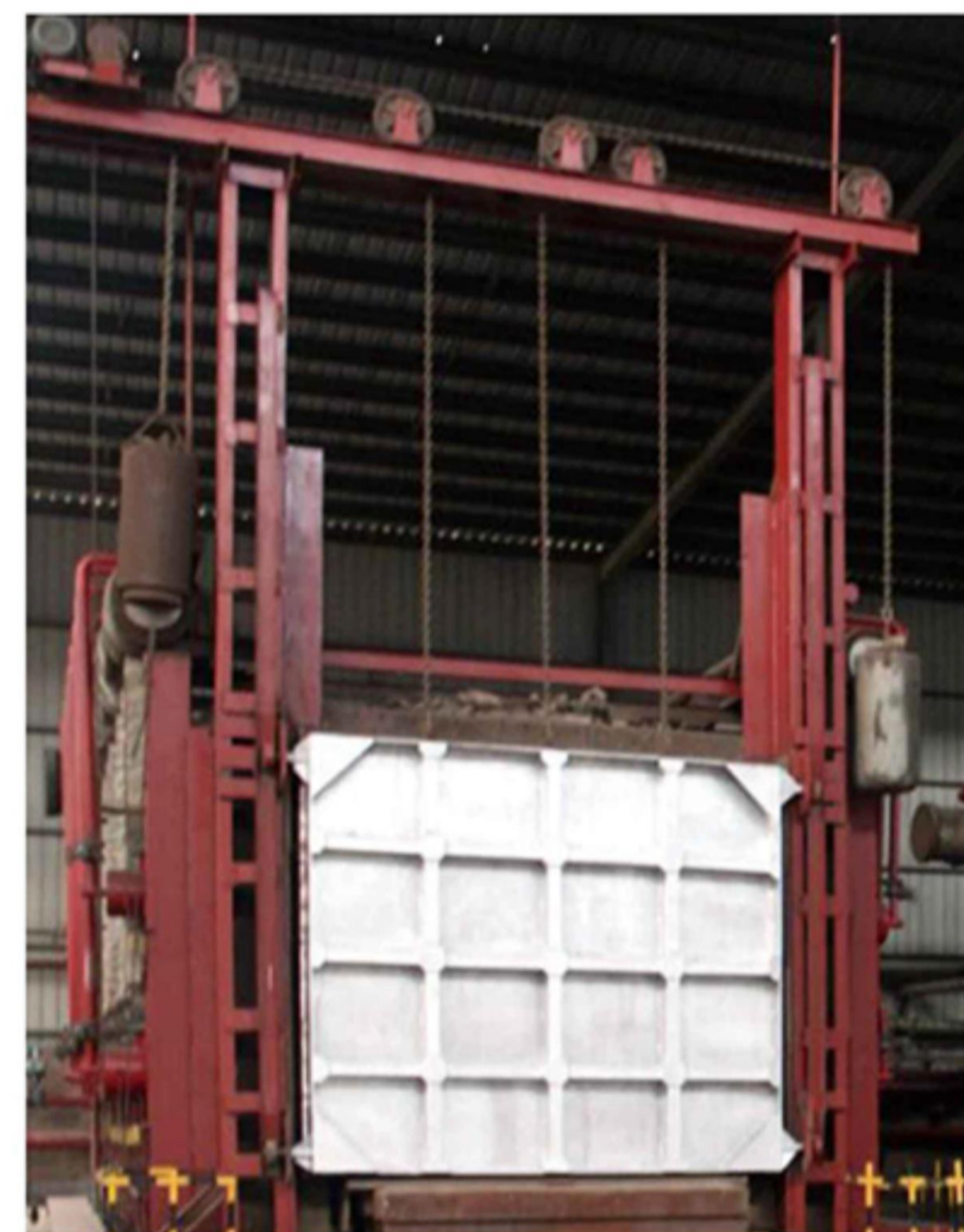
★主蒸汽管道热处理炉
