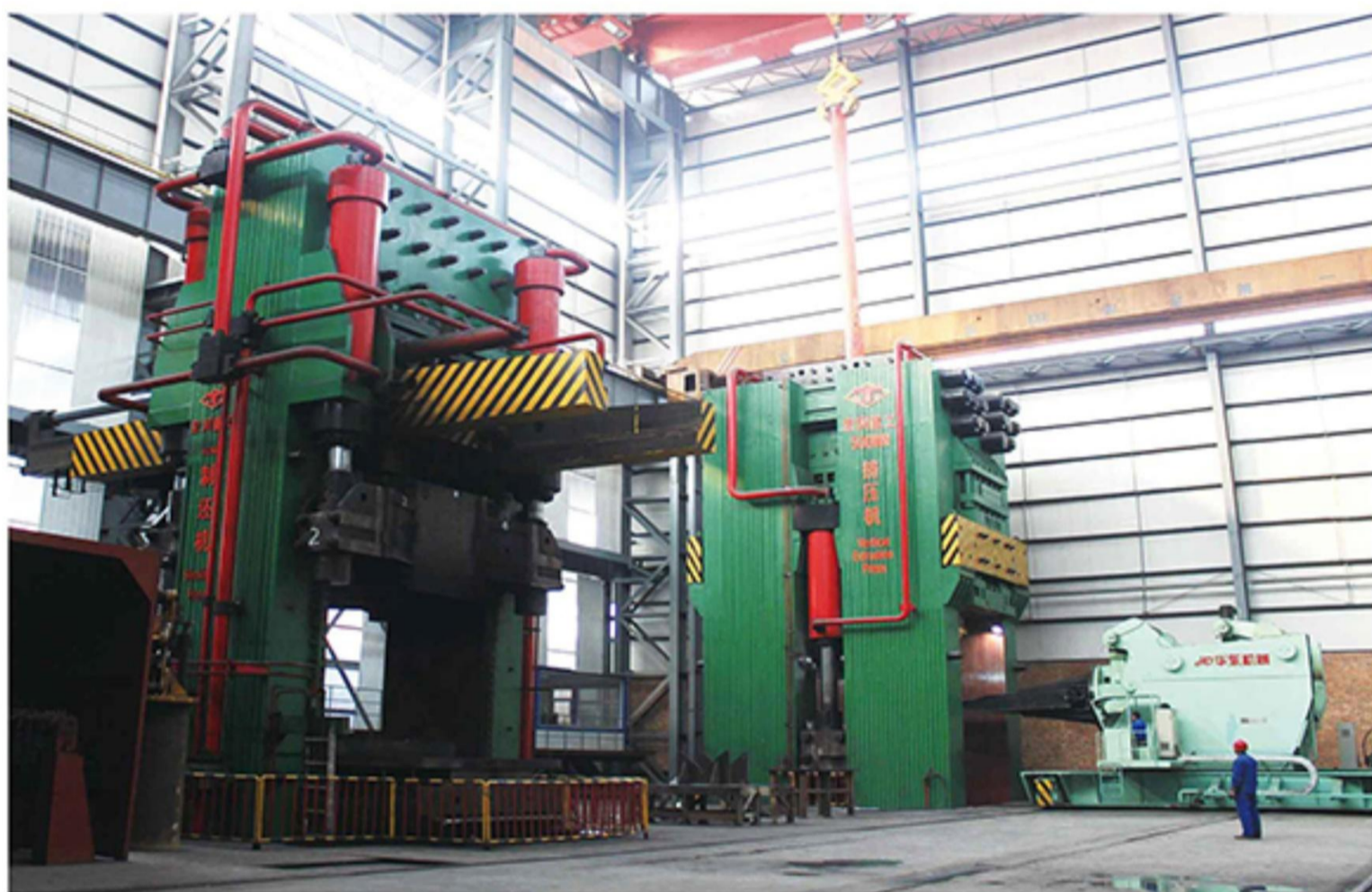
★世界首台5万吨主蒸汽管道压力机
