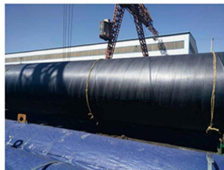
外环氧树脂、内水泥砂浆防腐钢管
