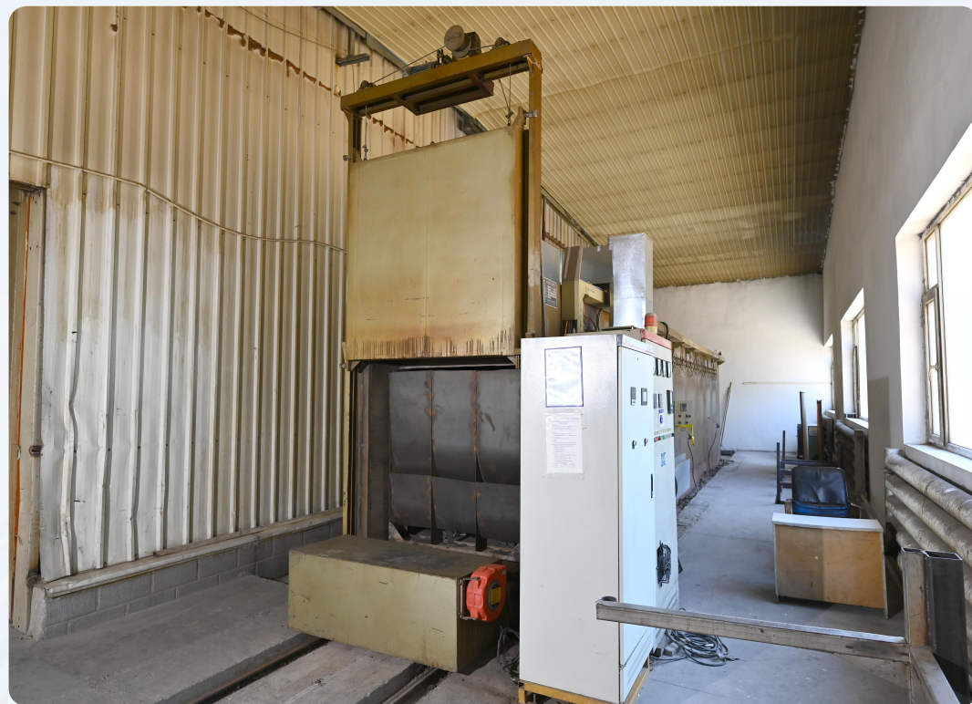
10米热时效处理炉
