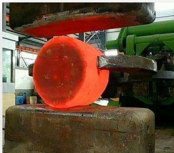
■ 锻造材料机械锻打消除缺陷
