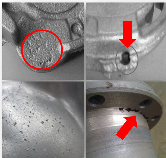
■ 铸造零件典型铸造缺陷
