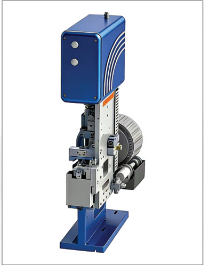
穿防水栓 工位
