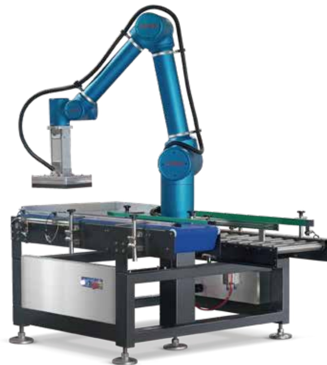
YSR-6-20-F/1600 协作机器人装箱机 Robot carton packer
