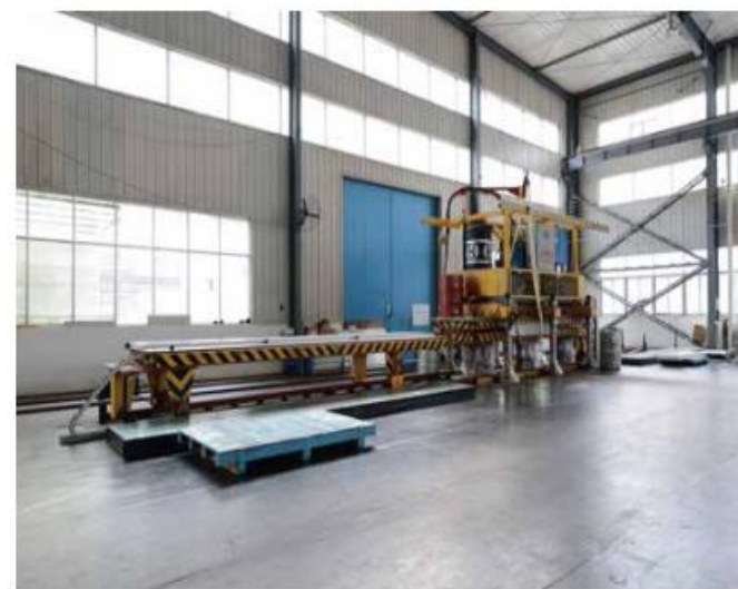
美国瑞科的聚胺脂高压喷射式发泡机组成的空调器保温面板生产线。
