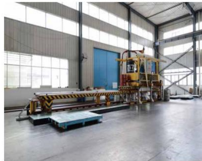
美国瑞科的聚氨酯高压喷射式发泡机组成的空调器保温面板生产线。
